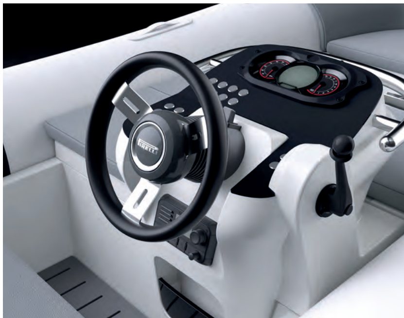
L'opzionale volante amovibile, tipico del mondo delle corse, riduce l'ingombro in caso di spazi bassi. The optional removable steering wheel, inspired to the racing world, reduces the tender's height when spaces are limited.
