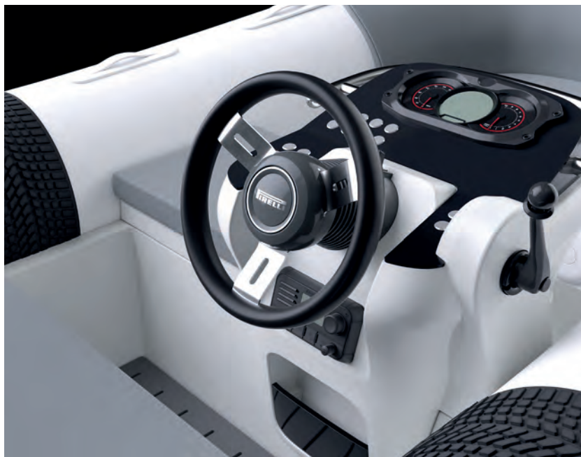
L'opzionale volante amovibile, ispirato al mondo delle corse, permette al tender di rientrare anche in spazi particolarmente bassi. The optional removable steering wheel, inspired to the racing world, allows the tender to fit into even very low spaces.
