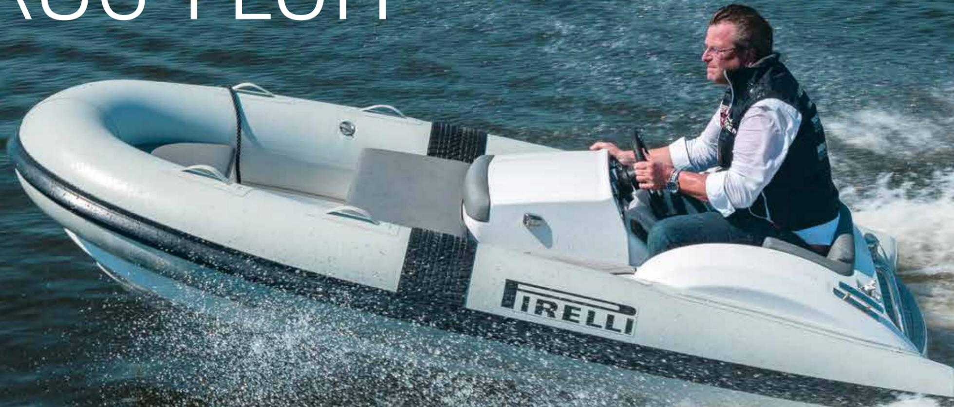
Die vom italienischen Hersteller TecnoRIB gefertigte Modellreihe »Pirelli Tenders« wurde so konstruiert, dass die Boote in die Heckgaragen großer Yachten passen und vornehmlich mit platzsparenden Jet-Antrieben versehen werden. So haben wir uns die nur 3,30 m lange, aber 73,6 kW (100 PS) starke Pirelli J33 näher angesehen.
