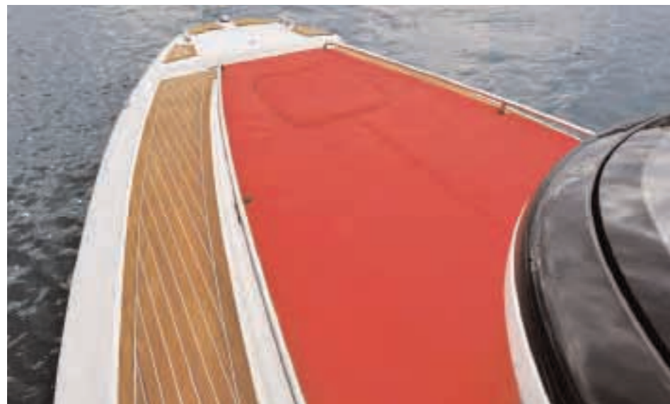
Il vertice è ampio e il pozzo catena è facilmente accessibile attraverso un grande portello. A richiesta il comando remoto per il verricello elettrico.
