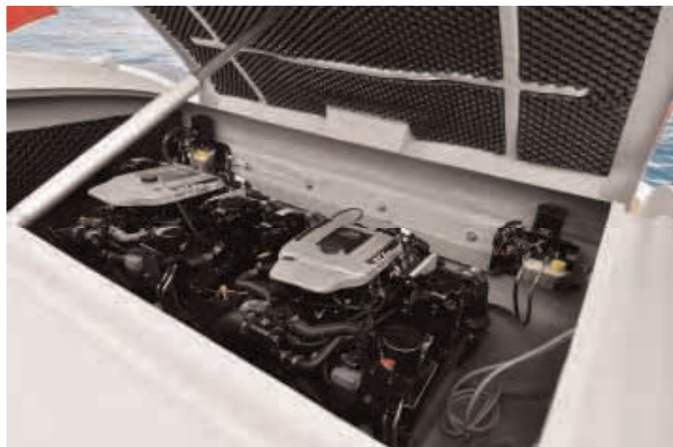
La plancetta poppiera è grande, attrezzata con scaletta bagno a scomparsa e maniglie per la risalita. Un attuatore elettro-idraulico apre la sala macchine mostrando il portellone rivestito con fonoassorbente.
